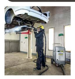
Das Strahlverfahren mit Trockeneis-Pellets ist ideal zur schonenden Reinigung sensibler Oberflächen – jetzt auch mit Trockeneis aus der Flasche!
