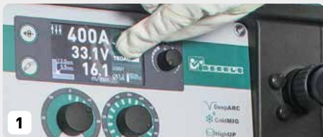
1 Komfortable Bedienung des Touchpanels per Fingertipp, absolut prozesssicher mit und ohne Handschuhe.
